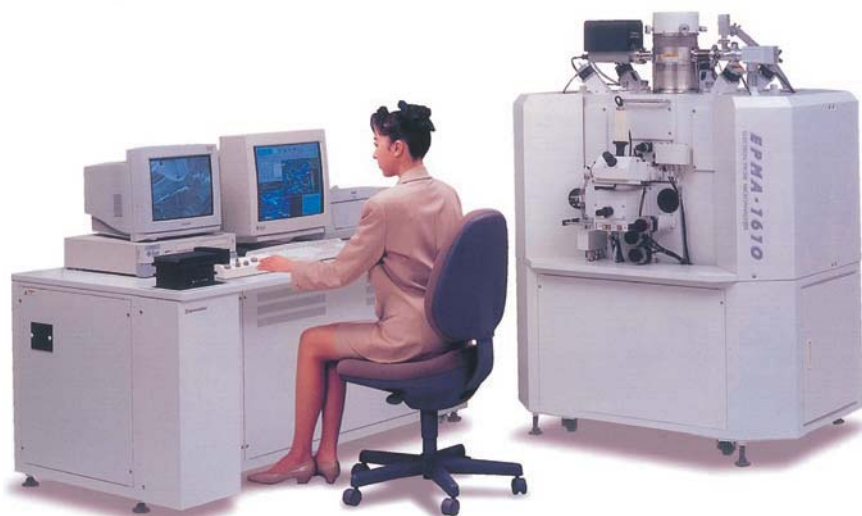
電子線マイクロアナライザー (EPMA) 電子線を照射して微小部の観察や元素分析を行います
